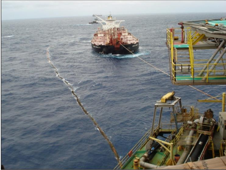
Ejemplo de *offloading* realizado en la Plataforma P-47 en el litoral norte del Estado de Rio de Janeiro.
