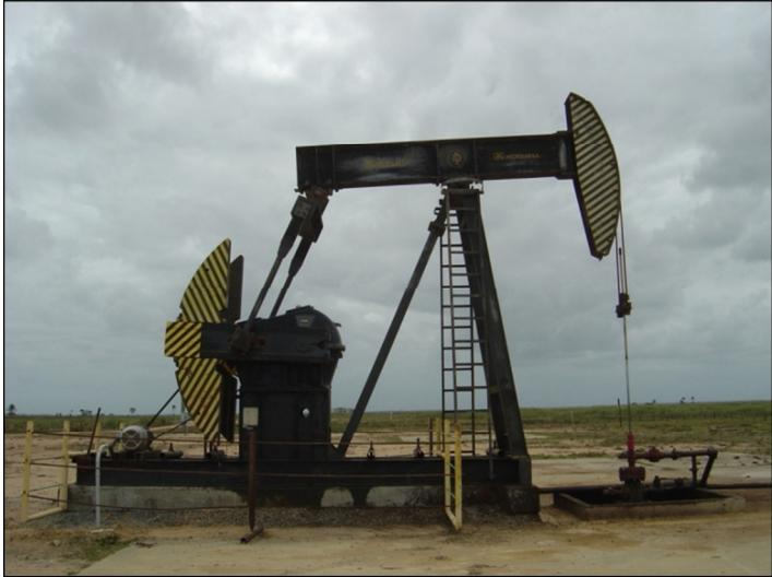
Aspectos de la exploración de petróleo al norte del río Doce, próximo al balneario Pontal do Ipiranga, donde se ve la perforación de un pozo y un caballo-mecánico ya instalado y produciendo.
